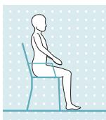
Wanneer het prothesebeen in zitstand wordt gehouden, d.w.z. wanneer het bovenbeen zich in bijna horizontale stand bevindt en het been onbelast is, vermindert het kniescharnier de weerstand zowel in de buig- als in de strekrichting.
