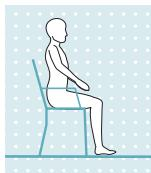
Se si trova in posizione seduta, vale a dire se la coscia è pressoché orizzontale e la gamba non sottoposta a carico, l'articolazione di ginocchio impone una resistenza minore sia in direzione di flessione, sia in direzione di estensione. Se quando ci si siede la protesi non viene caricata sufficientemente, l'azione di sedersi avverrà a gamba distesa. Attraverso la posizione della gamba pressoché orizzontale l'ammortizzazione viene ridotta e ha luogo un abbassamento autonomo della gamba.
