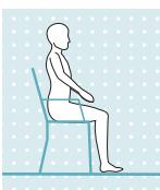
Wanneer het prothesebeen langer dan twee seconden in zitstand wordt gehouden, d.w.z. wanneer het bovenbeen bijna horizontaal wordt gehouden en het been onbelast is, vermindert het kniescharnier de weerstand in de strekrichting tot de minimumwaarde.
