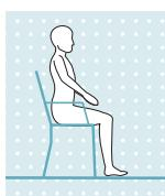
Liegt für länger als zwei Sekunden eine Sitzposition vor, d. h. der Oberschenkel ist annähernd waagerecht und das Bein unbelastet, schaltet das Kniegelenk den Widerstand in Streckrichtung auf ein Minimum.
