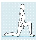
Permitir uma flexão controlada da articulação de joelho com uma resistência aumentada à flexão e, assim, atingir gradativamente a posição ajoelhada. Recomendamos evitar um impacto forte do joelho no chão para não danificar o sistema eletrônico.
