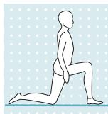
Autoriser une flexion contrôlée de l'articulation de genou avec une résistance à la flexion élevée pour atteindre progressivement la position à genoux. Il est recommandé d'éviter un choc important du genou sur le sol afin de ne pas endommager l'électronique.
