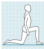
Permita que la articulación de rodilla se flexione de forma controlada bajo una resistencia de flexión aumentada, llegando así poco a poco a ponerse de rodillas. Hay que evitar poner de golpe la rodilla en el suelo para evitar que se dañe el sistema electrónico.
