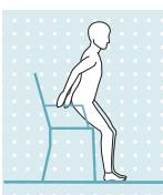
De weerstand van het product bij het gaan zitten zorgt ervoor dat de prothese gelijkmatig inzakt en ondersteunt daarbij de contralaterale zijde.
