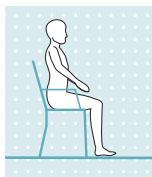
En cas de position assise pendant plus de deux secondes, c'est-à-dire que la cuisse se trouve quasiment à l'horizontale et que la jambe n'est pas sollicitée, l'articulation de genou règle la résistance à un niveau minimum dans le sens de l'extension.
